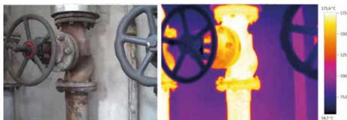
TERMOGRAFÍA DE VÁLVULA AISLADA
